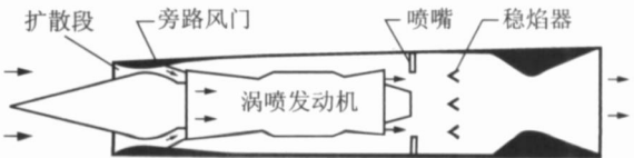
图 2 串联式涡轮冲压组合发动机
